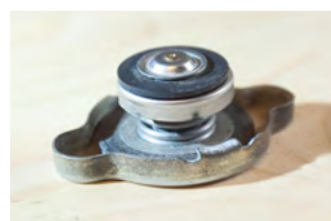
Vatnskassalok með of stífum gormi olli ofþrýstingi í kælikerfi. Tærður áfyllingarstútur sem gleymdist að skipta út varð orsök skemmda á olíuverki.
